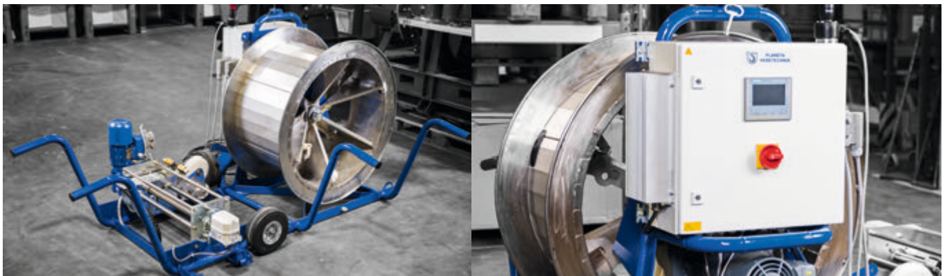
Mobile Seilwinde und Spulvorrichtung zum Sondieren von Abwasserkanälen
