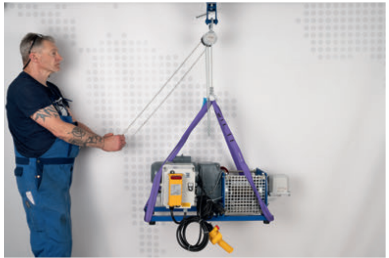
Anwendungsbeispiel: Bediener steht links neben der Last
