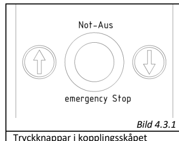
Tryckknappar i kopplingsskåpet
