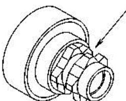
Extremer Verschleiß und Beschädigung am Kettenrad (Lastrolle)
