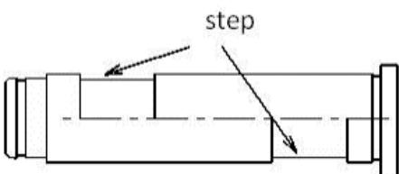
Zu ersetzen, falls der Zahnradbolzen an der Oberfläche eingelaufen ist.
