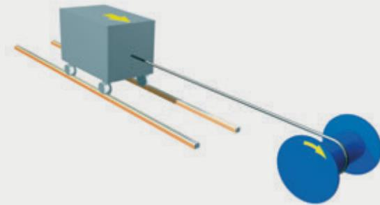
**Hubwinden** sind dann einzusetzen, wenn eine Last durch die Seilwinde gehoben und gehalten wird. Dies gilt für vertikalen Hub, aber auch für das Ziehen einer Last über eine schiefe Bahn. Seilwinden für den Hubbetrieb sind standardmäßig mit Federdruckbremsen am Motor ausgerüstet und garantieren damit ein sicheres Halten der Last. Zudem werden Seilwinden für den Hubbetrieb mit höheren Sicherheitsfaktoren ausgelegt als beispielsweise Seilwinden für den reinen Zugbetrieb.
