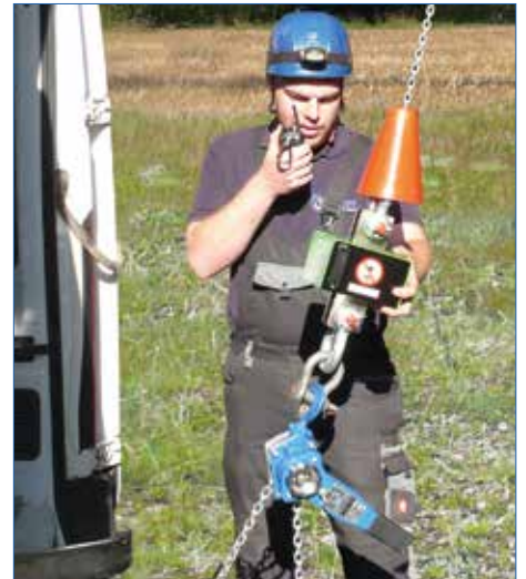
Lastprobe von Hebezeugen in Windkraftanlagen
