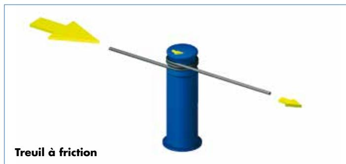
**Les treuils de traction** sont également, comme les treuils à friction, des treuils en continu. Ils fonctionnent selon le même principe de l'amplification des forces par la friction de l'enroulement. Grâce à leur construction avec deux disques d'entraînement et plusieurs rainures, le câble est mieux guidé et protégé. Habituellement, des treuils de traction se trouvent sur des chariots de va-et-vient. Le câble de traction est tendu entre les deux extrémités de la piste de roulement.
